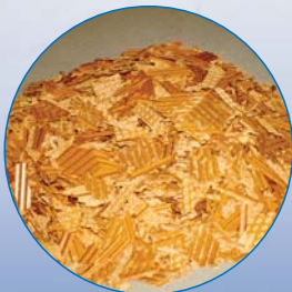
Calcaire d'un échangeur de chaleur
